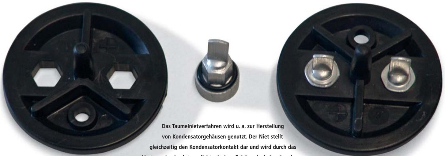
Das Taumelnietverfahren wird u. a. zur Herstellung von Kondensatorgehäusen genutzt. Der Niet stellt gleichzeitig den Kondensatorkontakt dar und wird durch das Vertaumeln absolut gasdicht mit dem Gehäusedeckel verbunden.
