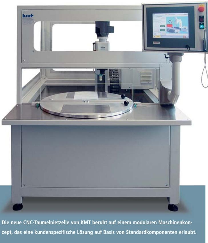
Die neue CNC-Taumelnietzelle von KMT beruht auf einem modularen Maschinenkonzept, das eine kundenspezifische Lösung auf Basis von Standardkomponenten erlaubt.
